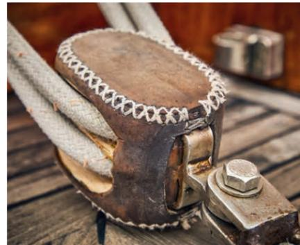
Blöcke an Bord sind von Hand beledert, das schützt Schiff, Beslätze und Besatzung
